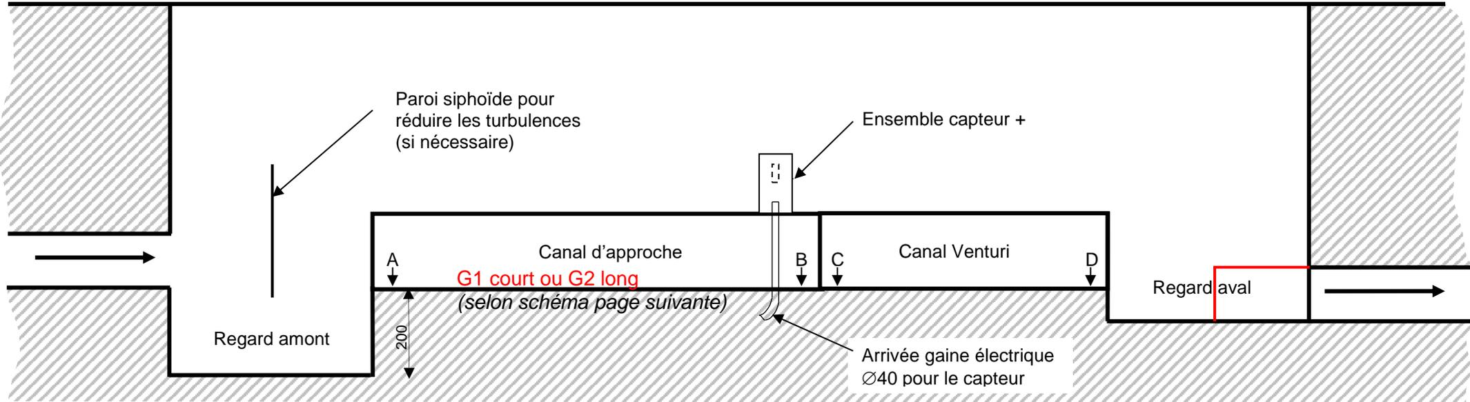
**Le plan A-B-C-D doit être parfaitement horizontal**
