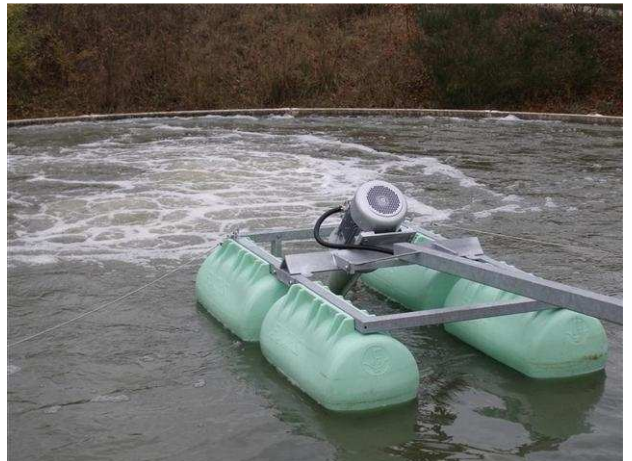
Aérateur monté sur suspension flottante
