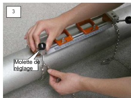
3. Bloquer la chaîne avec la molette de réglage
