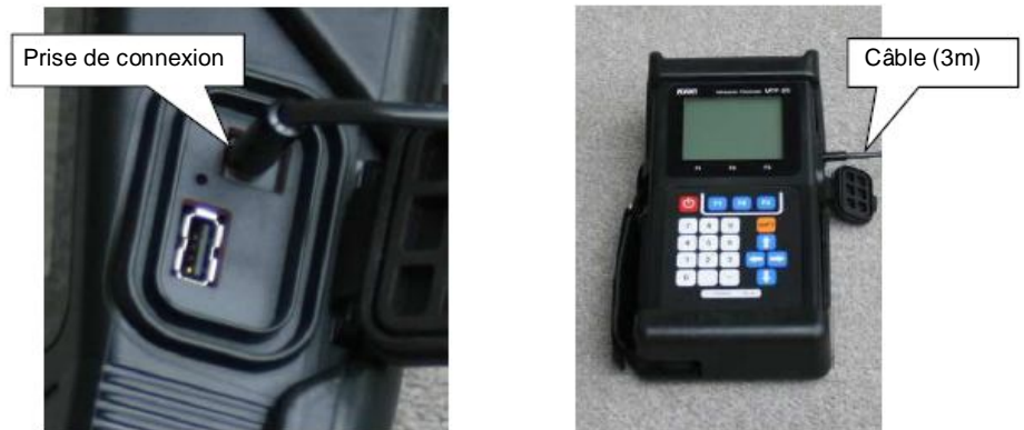
Fig. 1.2.4-12 Connexion du câble de l'allume cigare
