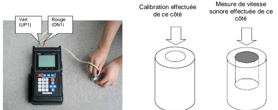
Fig. 1.2.4-9 Mesure de l'épaisseur et de la vitesse sonore
