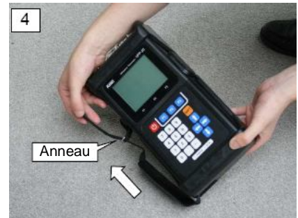
4 Après avoir placé le côté inférieur de l'appareil dans l'étui de protection, insérer la poignée dans l'anneau
