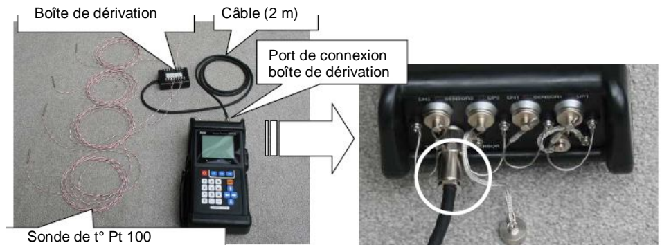
Fig. 1.2.4-4 Branchement des sondes de température
