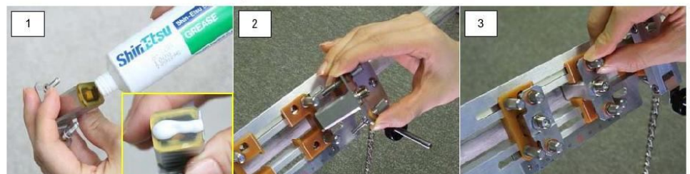
Fig. 1.2.9-5 Installer les capteurs sur le dispositif de fixation
