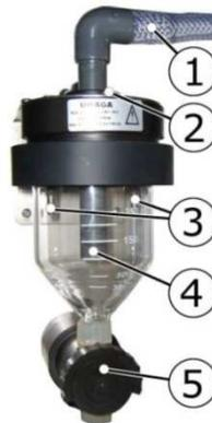
La partie supérieure du préleveur est dotée d'un verre doseur et d'un système de pompe à vide:
