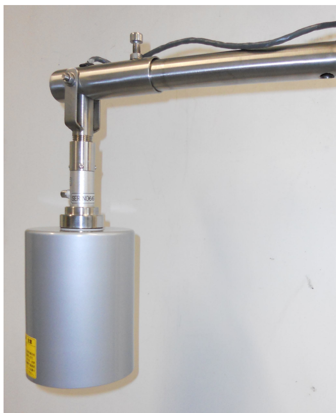
Photo de montage de la tête de détection sur paroi verticale
