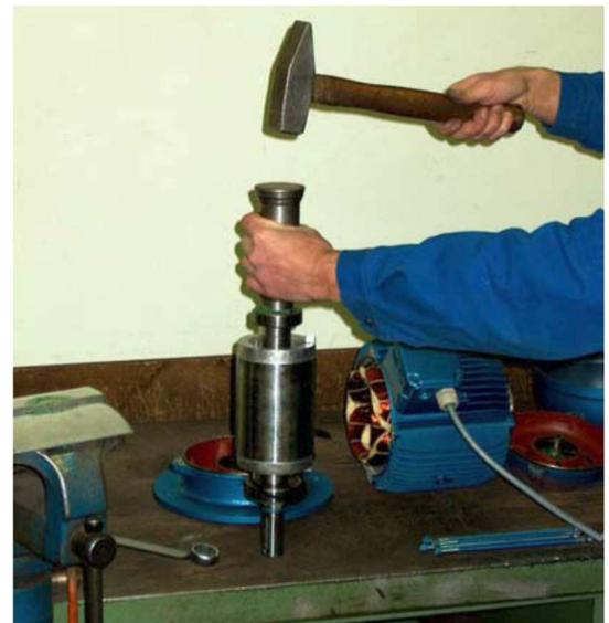
Procéder au remontage du tube d'aération après un nettoyage complet. Graisser légèrement les portées cylindriques et coniques avec une graisse sans acide.
