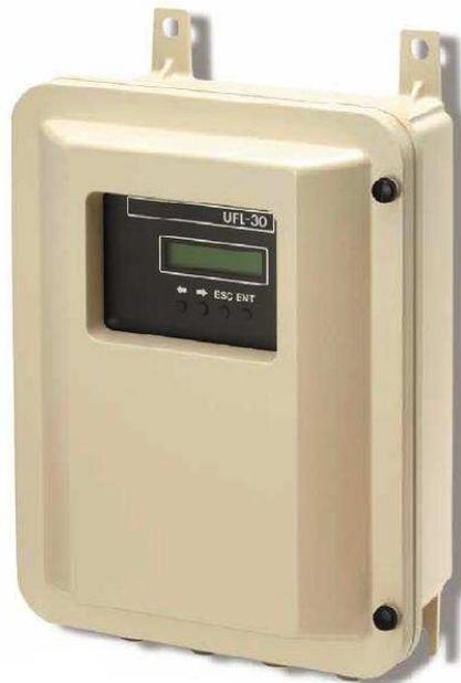
Le nouveau débitmètre à ultrasons fixe type UFL-30, non intrusif, s'adapte pour des conduites  $\varnothing$  DN 25 à DN 6000 mm et s'applique pour des vitesses d'écoulement de l'eau de  $\pm 30$  m/s maximum.
