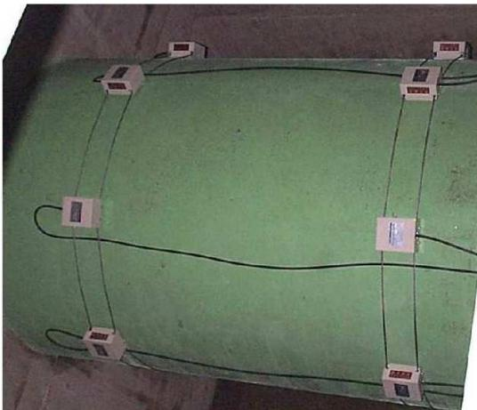
Le modèle UFL-30 offre des capacités de mesure allant d'une paire de capteur simple jusqu'à quatre paires dont les réglages sont très faciles à configurer et à installer. Le mode mesure multipoints donne la moyenne des valeurs mesurées de chaque paire pour une meilleure stabilité et une plus haute précision même avec une longueur droite plus courte que nécessaire.
