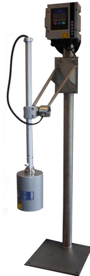
Notre appareil est utilisé pour surveiller la présence d'hydrocarbures à la surface de l'eau en continu (par exemple dans un canal). Lors de la détection d'un film d'hydrocarbures à la surface de l'eau, le système génère une alarme par l'intermédiaire d'un relais.
