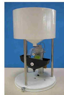
Pluviomètre à augets
