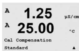
Tous les autres modèles proposent les options Standard, Lin20°C = 02.0%/°C (valeur sélectionnable par l'utilisateur) et Lin25°C = 02.0%/°C (valeur sélectionnable par l'utilisateur) comme mode Compensation via l'étalonnage.
