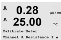
Accédez à l'écran d'étalonnage de l'instrument et sélectionnez le canal A ou B, et Résistance 1, pour indiquer que le transmetteur est prêt à étalonner la résistance de première gamme. Cette résistance peut être modifiée en effectuant une sélection parmi les domaines 1 à 5. Chaque gamme de résistance se compose d'un étalonnage en deux points.
