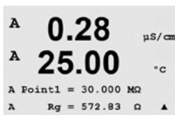
Saisissez la valeur du Point 2 de l'étalonnage en fonction de la résistance connectée via l'entrée de mesure de l'électrode de verre pH.
