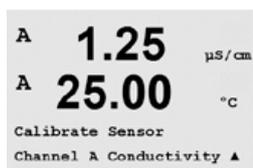
Accédez au mode Calibrage de la sonde de conductivité conformément à la description de la section 7.1 « Accès au mode Calibrage ».
