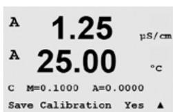
Une fois l'étalonnage effectué, le multiplicateur ou facteur M d'étalonnage de la pente et l'additionneur ou le facteur A d'étalonnage du décalage sont affichés.
