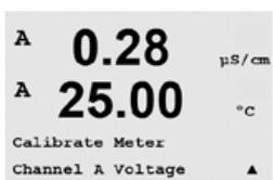
Saisissez la valeur en volts pour le Point 1 connecté à l'entrée. La tension mesurée est affichée sur la deuxième ligne. Appuyez sur [ENTER] pour démarrer l'étalonnage.
