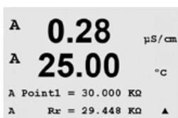
Saisissez la valeur du Point 2 de l'étalonnage en fonction de la résistance connectée via l'entrée de mesure de la référence pH.
