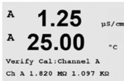
Le signal mesuré pour la mesure principale et secondaire s'affiche dans l'unité électrique. Les facteurs d'étalonnage de l'instrument de mesure sont utilisés lors du calcul de ces valeurs.
