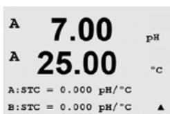
STC représente le coefficient de température de la solution en pH/°C à 25 °C (par défaut = 0,000 pour la plupart des applications). Pour l'eau pure, une valeur de 0,016 pH/°C doit être utilisée. Pour des échantillons de centrales thermiques à faible conductivité, proche de 9 pH, une valeur de 0,033 pH/°C doit être utilisée. Ces coefficients positifs compensent l'influence négative de la température sur le pH de ces échantillons. Appuyez sur la touche [ENTER].
