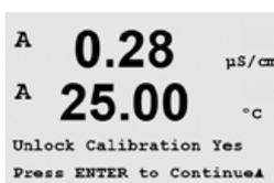
Sélectionnez Oui pour que les menus d'étalonnage de l'instrument (voir le chapitre 11.3.1 « Étalonnage de l'instrument ») et des sorties courant (voir le chapitre 11.3.2 « Étalonnage des sorties courant ») soient accessibles via le menu CAL. Sélectionnez Non pour que seul l'étalonnage de la sonde soit disponible dans le menu CAL. Après la sélection, appuyez sur [ENTER] pour afficher un message de confirmation.
