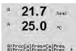
Pour l'algorithme d'étalonnage du procédé, la pression appliquée (ProcCalPres) doit être définie. La valeur de la pression de procédé (ProcPres) ou de la pression d'étalonnage (CalPres) peut être utilisée. Choisissez la pression à appliquer lors de l'étalonnage du procédé en fonction de l'algorithme et appuyez sur la touche [ENTER].
