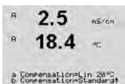
La compensation linéaire à 20 °C ajuste la lecture au moyen d'un facteur exprimé comme un « % par °C » en cas d'écart par rapport à 20 °C. À n'utiliser que si la solution a un coefficient de température linéaire bien défini. La valeur usine par défaut est de 2,0 %/°C.
