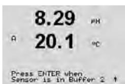
Placez l'électrode dans la deuxième solution tampon et appuyez sur la touche [ENTER] pour démarrer l'étalonnage.
