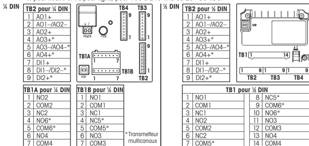
NO = normalement ouvert (contact est ouvert si non activé). NC = normalement fermé (contact est ferme si non activé).
