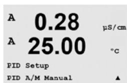
Ce menu permet de choisir entre un fonctionnement automatique ou manuel. Choisissez le mode de fonctionnement du PID (Auto ou Manuel). Appuyez sur [ENTER] pour afficher la boîte de dialogue Sauver changements.
