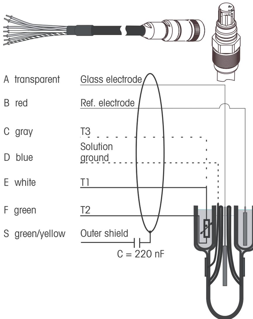
T1/T2 = sonde de température pour connexion à 2 fils
