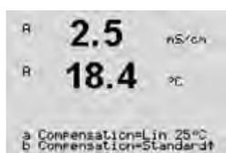
La compensation linéaire à 25 °C ajuste la lecture au moyen d'un facteur exprimé comme un « % par °C » en cas d'écart par rapport à 25 °C. À n'utiliser que si l'échantillon possède un coefficient de température linéaire bien défini. La valeur usine par défaut est de 2,0 %/°C.
