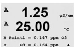
Une fois l'étalonnage effectué, le facteur S d'étalonnage de la pente et le facteur Z d'étalonnage du décalage sont affichés.
