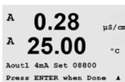
Lorsque le nombre à cinq chiffres augmente, le courant aussi ; lorsque le nombre diminue, le courant de la sortie suit la même courbe. Par conséquent, des changements grossiers peuvent être apportés au courant de sortie en modifiant les chiffres des centaines et des milliers ; des changements précis peuvent être effectués en modifiant les chiffres des dizaines et des unités.
