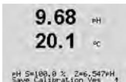
Une fois l'étalonnage effectué, le facteur S d'étalonnage de la pente et le facteur Z d'étalonnage du décalage sont affichés. Choisissez Oui pour enregistrer les nouvelles valeurs d'étalonnage, le message « Calibrage réussi » s'affiche. En cas de connexion de sonde ISM, les données d'étalonnage sont enregistrées dans la sonde. Le A ou le B situé dans l'angle supérieur gauche s'efface après 20 secondes.
