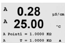
La première ligne de texte demande la valeur de température du point 1 (cela correspond à la valeur de la température 1 affichée sur le module d'étalonnage). La seconde ligne de texte indique la valeur de résistance mesurée. Lorsque la valeur se stabilise, appuyez sur [ENTER] pour effectuer l'étalonnage.
