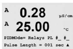
Ce menu affecte un relais ou une sortie courant pour le contrôle du PID et détaille leur fonctionnement. Selon le dispositif de contrôle utilisé (électrovanne, pompe doseuse à entrée d'impulsion ou contrôle analogique), choisissez parmi les trois paragraphes suivants.
