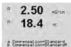
Le mode compensation de température peut être sélectionné pour n'importe laquelle des quatre lignes de mesure. La compensation de température doit être adaptée aux caractéristiques de l'application. Les choix sont Aucune\*, Standard, Light 84\*, Std 75°C\*, Lin25°C, Glycol.5\*, Glycol1\*, Cation\*, Alcool\*, NH3 et Lin20°C.
