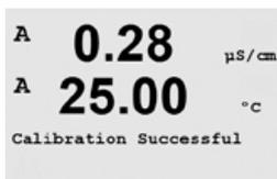
Le transmetteur revient en mode de mesure au bout de 5 secondes environ.
