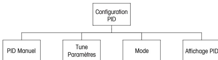
La régulation du PID est une action de contrôle proportionnelle, intégrale et dérivée capable de réguler en douceur un procédé. Avant de configurer le transmetteur, les caractéristiques de procédé suivantes doivent être définies.
