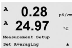
Appuyez sur la touche [ENTER] pour sélectionner ce menu. La méthode de filtrage (filtre de bruit) pour chaque ligne de mesure peut désormais être sélectionnée. Les options sont Spécial (Par défaut), Aucune, Bas, Moyen et Haut :
