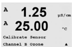
Accédez au mode d'étalonnage de l'ozone conformément à la description de la section 7.1, « Accès au mode Calibrage », et sélectionnez Ozone.
