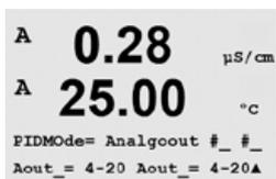
**Analogique** – si vous utilisez un contrôle analogique, passez de l'option Relais à AnalOut (Sortie courant) à l'aide des touches fléchées haut/bas. Choisissez la position de la première sortie courant #1 et/ou la position de la deuxième sortie courant #2 conformément au tableau ci-dessous. Sélectionnez la plage de courant de la sortie courant exigée par le dispositif de contrôle, à savoir 4–20 ou 0–20 mA. Appuyez sur la touche [ENTER].
