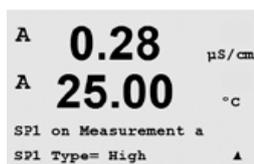
Il est possible de configurer jusqu'à 4 valeurs de consigne (6 pour la version à deux canaux) sur un canal (a à d). Les types de valeurs disponibles sont Off, Haut, Bas, Outside et Between. Les modèles Thornton comportent également les types, %USP, %EP PW et %EP WFI pour la configuration avec des sondes de conductivité.
