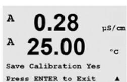
Une fois les points 1 et 2 étalonnés, revenez à l'écran Calibrer Transm. Déplacez le curseur de Canal A à Résistance 2, qui désigne la seconde gamme d'étalonnage. Effectuez l'étalonnage en deux points de la même façon que pour la première gamme. Le même procédé doit être suivi pour réaliser l'étalonnage de la résistance des 5 gammes.
