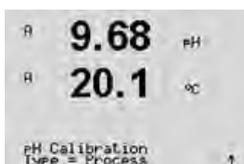
Sélectionnez Calibrage du procédé. Avec les électrodes de pH, un étalonnage de procédé est toujours réalisé comme un étalonnage de la pente.
