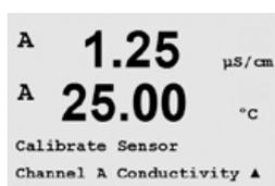
En mode Mesure, appuyez sur la touche ►. Si un message vous invite à saisir le code de sécurité de l'étalonnage, appuyez sur la touche ▲ ou ▼ pour régler le mode de sécurité de l'étalonnage, puis appuyez sur [ENTER] pour confirmer le code de sécurité de l'étalonnage.
