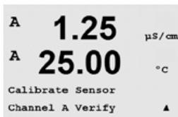
Accédez au mode d'étalonnage conformément à la description de la section 7.1, « Accès au mode Calibrage », et sélectionnez Vérifier.
