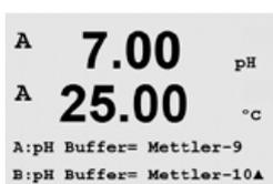
Pour la reconnaissance automatique du tampon au cours de l'étalonnage, sélectionnez le jeu de solutions tampons utilisé : Mettler-9, Mettler-10, NIST Tech, NIST Std, HACH, CIBA, MERCK, WTW ou None (Aucun). Voir la section 20, « Tableaux de tampons », pour les valeurs des tampons. Si la fonction de tampon automatique n'est pas utilisée ou si les tampons disponibles diffèrent des tampons ci-dessus, sélectionnez Aucun. Appuyez sur la touche [ENTER].
