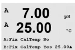
Il est possible de saisir une **température d'étalonnage fixe**. L'option « Fixe » permet de saisir une valeur de température spécifique. Si vous sélectionnez Non, la température configurée dans la section 8.3.2, « Source de température » sera utilisée pour l'étalonnage. Appuyez sur la touche [ENTER].
