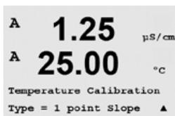
Sélectionnez Calibrage 1 point. Pente ou Offset peuvent être sélectionnés avec l'étalonnage en un point. Sélectionnez Pente pour recalculer le facteur M (Multiplicateur) de pente ou Offset pour recalculer le facteur A (Additionneur) d'étalonnage du décalage.
