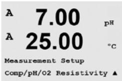
Pour les instruments à deux canaux : Le menu Comp/pH/O2 peut être sélectionné à l'aide de la touche ▲ ou ▼. Utilisez ensuite la touche ► pour accéder au champ de saisie suivant et sélectionnez le paramètre à l'aide de la touche ▲ ou ▼. Les choix sont Résistivité (pour la mesure de la conductivité), pH et O2. Appuyez sur la touche [ENTER].
