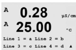
Sélectionnez le mode Erreur Affichage. Si ce paramètre est activé, lorsqu'une alarme se produit, le message « Erreur – Presser ENTER » s'affiche sur la ligne 4 en mode de mesure normal.
