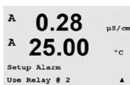
Utilisez les touches ◀ et ▶ pour accéder à Utiliser le relais #. Utilisez les touches ▲ ou ▼ pour sélectionner un relais à utiliser pour l'alarme et appuyez sur la touche [ENTER].
