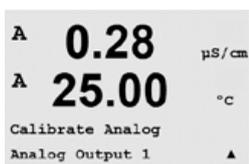
Sélectionnez la sortie courant à étalonner. Chaque sortie courant peut être étalonnée à 4 et 20 mA.
