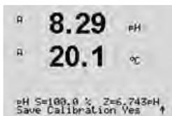
Choisissez Oui pour enregistrer les valeurs d'étalonnage, le message « Calibrage réussi » s'affiche. En cas de connexion de sonde ISM, les données d'étalonnage sont enregistrées dans la sonde.
