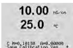
Une fois l'étalonnage effectué, le multiplicateur ou facteur M d'étalonnage de la pente et l'additionneur ou le facteur A d'étalonnage du décalage sont affichés.
