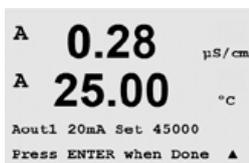
Connectez un milliampèremètre précis à la sortie courant, puis ajustez le nombre à cinq chiffres à l'écran pour régler la sortie sur 4.00 mA. Répétez l'opération pour 20.00 mA.
