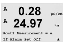
Lorsqu'une valeur d'alarme est sélectionnée, la sortie courant y accédera si l'une des conditions d'alarme se produit.
