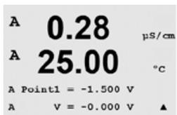
Saisissez la valeur en volts pour le point 2 de la source connectée à l'entrée. La tension mesurée est affichée sur la deuxième ligne.
