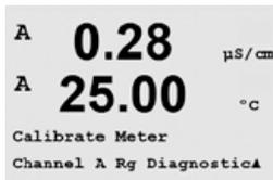
Saisissez la valeur du Point 1 de l'étalonnage en fonction de la résistance connectée via l'entrée de mesure de l'électrode de verre pH. Appuyez sur [ENTER] pour démarrer l'étalonnage.
