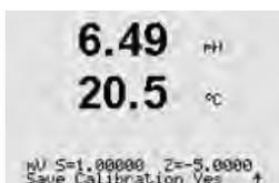
Z correspond au dernier calcul du facteur d'étalonnage du décalage. Le facteur S d'étalonnage de la pente est toujours égal à 1 et n'intervient pas dans le calcul.
