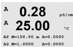
P = constantes d'étalonnage de la mesure principale
