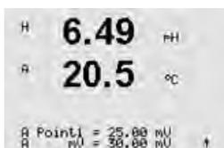
Saisissez la valeur du Point 1. Le facteur d'étalonnage du décalage est calculé en utilisant la valeur du Point1 à la place de la valeur mesurée (ligne 4, mV = ...) et est affiché à l'écran suivant.
