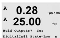
La fonction « **Numér.In** » s'applique constamment. Dès qu'un signal est actif sur l'entrée numérique, le transmetteur passe en mode Hold et les valeurs de la sortie courant, des relais de sortie et de la sortie USB sont maintenues.
