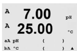
Les 4 lignes de l'écran peuvent ensuite être configurées avec le canal A ou B de la sonde pour les différentes lignes ainsi qu'avec les mesures et les multiplicateurs d'unités. Appuyez sur la touche [ENTER] pour afficher la sélection des lignes c et d.
