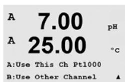
« Ce Canal Pt1000 » : l'entrée de température provient de la sonde connectée.
