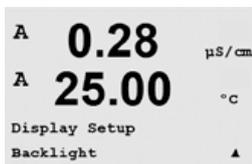
Les paramètres disponibles sont Act., Act. 50% ou Auto 50%. Si l'option Auto 50% est sélectionnée, le rétroéclairage est réduit à 50 % de ses capacités après 4 minutes d'inactivité au niveau du clavier. Le rétroéclairage s'active de nouveau automatiquement si une touche est enfoncée.
