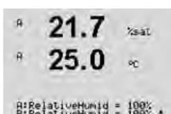
De plus, l'humidité relative du gaz d'étalonnage peut également être saisie. Les valeurs autorisées pour l'humidité relative sont comprises entre 0 % et 100 %.
