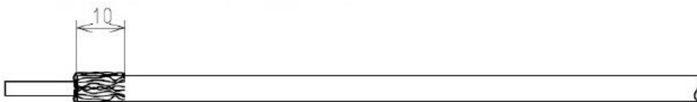
Fig. 1-2-4-6 Préparation de l'extrémité du câble (2)
