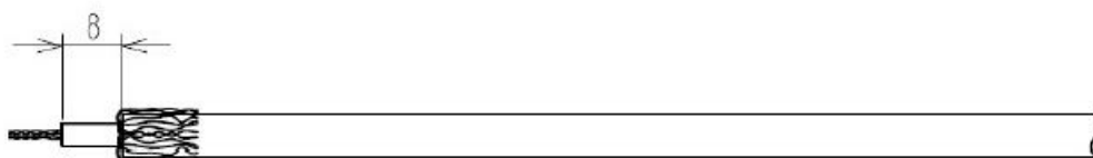
Fig. 1-2-4-7 Préparation de l'extrémité du câble (3)
