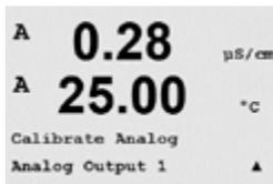
Connectez un milliampèremètre précis à la sortie analogique, puis ajustez le nombre à cinq chiffres à l'écran pour régler la sortie sur 4,00 mA. Répétez l'opération pour 20,00 mA.
