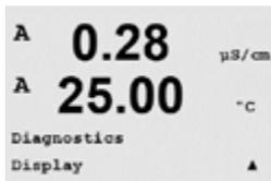
Tous les pixels de l'écran s'allument pendant 15 secondes pour permettre de détecter les éventuels problèmes. Au bout de 15 secondes, le transmetteur revient au mode de mesure normal ; pour quitter plus tôt, appuyez sur [ENTER].
