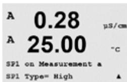
Il est possible de configurer jusqu'à 4 Setpoints (seuils) sur un canal (a à d). Les types de seuils disponibles sont Off (Désactivé), High (Haut), Low (Bas), Outside (Extérieur) et Between (Intermédiaire).
