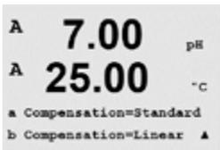
Le mode compensation de température peut être sélectionné pour n'importe laquelle des quatre lignes de mesure. La compensation de température doit être adaptée aux caractéristiques de l'application. Les choix sont Standard (Standard), Light 84 (Light 84), Std 75 °C (Std 75 °C), Lin 20 °C (Linéaire), Lin 25 °C (Linéaire), Nat H<sub>2</sub>O, Glycol.5, Glycol1, Cation (Cationique), Alcohol (Alcool) et Ammoniac (Ammoniac).
