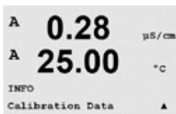
La sélection de Calibration Data (Données d'étalonnage) permet d'afficher les constantes d'étalonnage pour chaque sonde. Utilisez les touches Haut et Bas pour basculer entre les canaux A et B.
