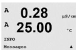
Appuyez sur la touche ▼ pour afficher le menu Info avec les options Messages, Calibration Data (Données d'étalonnage) et Model/Software Revision (Modèle/version logicielle).
