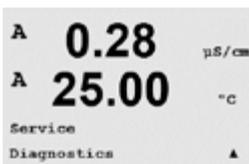
Ce Menu est un outil précieux pour le dépannage et permet de diagnostiquer les éléments suivants : Model/Software Revision (Modèle/version logicielle), Digital Input (Entrée numérique), Display (Écran), Keypad (Clavier), Memory (Mémoire), Set Relays (Réglage des relais), Read Relays (Lecture des relais), Set Analog Outputs (Réglage des sorties analogiques), Read Analog Outputs (Lecture des sorties analogiques).
