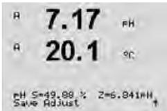
Dès que les conditions de dérive sont stabilisées, l'affichage se modifie et indique le facteur S d'étalonnage de la pente ainsi que le facteur Z d'étalonnage du décalage.
