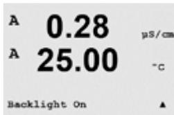
Les paramètres disponibles sont On (activation), On 50% (activation 50%) ou Auto Off 50% (désactivation auto 50%). Si Auto Off 50% (désactivation auto 50%) est sélectionné, le rétroéclairage est réduit à 50% de ses capacités après 4 minutes d'inactivité au niveau du clavier. Le rétroéclairage s'active de nouveau automatiquement si une touche est enfoncée.
