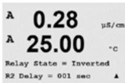
Chaque relais d'alarme peut être configuré en état Normal ou Inverted (Inversé). De plus, il est possible de définir un délai d'activation. Pour de plus amples informations, reportez-vous à la section 8.4 «Seuils».
