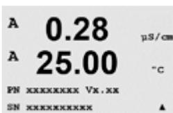
La touche ▼ permet de parcourir ce sous-menu et d'obtenir des renseignements supplémentaires comme la version du logiciel installé dans le transmetteur : Master V\_XXXX et Comm V\_XXXX ; ainsi que la version du micrologiciel (FW V\_XXX) et du matériel constitutif de la sonde (HW XXXX).
