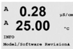
Sélectionnez Model/Software Revision (Modèle/version logicielle) pour afficher la référence, le modèle et le numéro de série du transmetteur et les informations concernant la ou les sondes raccordées.
