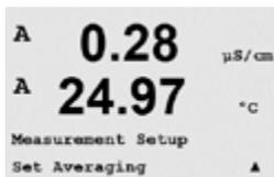
Appuyez sur la touche [ENTER] pour sélectionner ce menu. La méthode de la moyenne (filtre de bruit) pour chaque ligne de mesure peut désormais être sélectionnée. Les options sont Special (Par défaut), None (Aucun), Low (Bas), Medium (Moyen) et High (Haut) :
