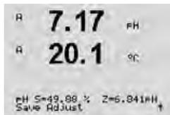
L'affichage fait apparaître le facteur S d'étalonnage de la pente et le facteur Z d'étalonnage du décalage.
