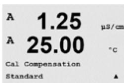
Après avoir sélectionné l'étalonnage de sonde souhaité et avoir appuyé sur [ENTER], l'écran suivant propose de choisir le type de mode de compensation de température désiré lors du procédé d'étalonnage. Les choix sont Standard, Light 84, Std 75 °C, Lin 20 °C = 02.0%/°C (valeur sélectionnable par l'utilisateur), Lin 25 °C = 02.0%/°C (valeur sélectionnable par l'utilisateur), Glycol.5, Glycol1, Alcohol et Nat H<sub>2</sub>O.
