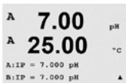
L'option Fixed (Fixe) permet de saisir une valeur de température spécifique. Si vous choisissez No (Non) la température indiquée par la sonde numérique raccordée au canal sera utilisée pour l'étalonnage.
