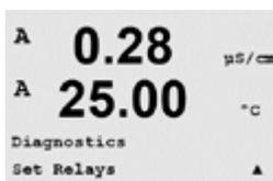
Le menu de diagnostic Set Relays (Réglage des relais) permet d'activer/désactiver chaque relais.
