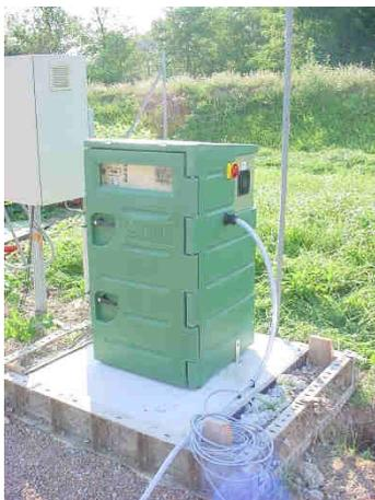
Piston de prélèvement sur conduite
