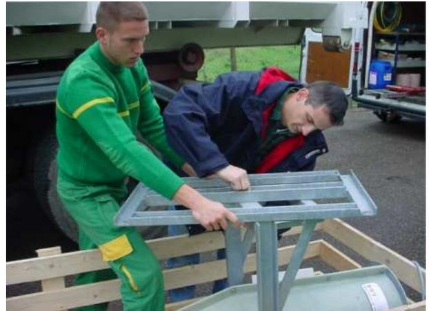
**Opération n° 7 :** Régler la profondeur d'immersion de l'hélice de l'aérateur, poser une règle en aluminium sur le cadre de la fourche de suspension. Régler la cote **T**, présenter le fer plat (tige d'arrêt) puis le percer de manière à figer l'angle d'inclinaison de l'aérateur dans l'eau
