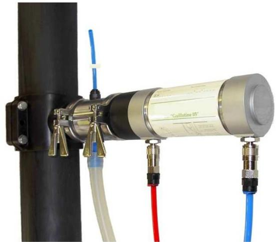
Le système "ILS" est un préleveur fixe automatique pour utilisation en conduite en charge. Le produit prélevé doit être liquide, sans air ni matière solide. Il est conçu pour prélever de l'eau usée brute (pression maximum 2 à 2,5 bars). Il est conforme aux normes ISO 5667-2 & 5667-10 et est équipé d'un déclencheur pneumatique (6-8 bars).
